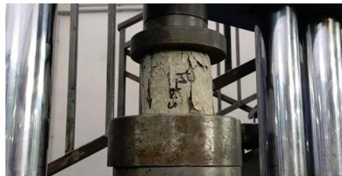
Nel caso di calcestruzzo consiste nel prelievo di un campione per sottoporre lo stesso a **prova di compressione sino a rottura**.
