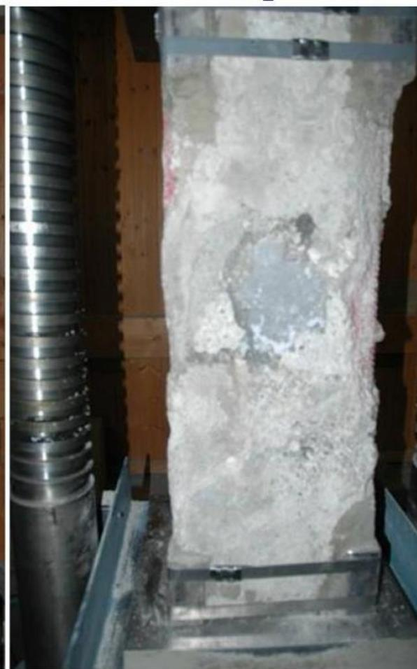
Prove di compressione su pilastri carotati (sx) integri (centro) e ripristinati (dx)
