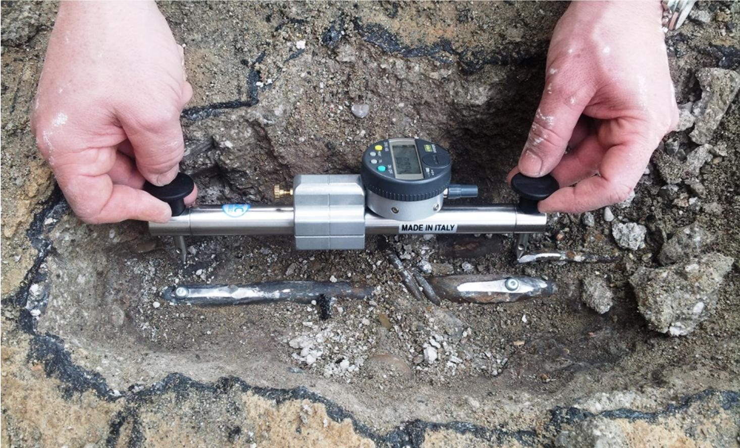
Misura della deformazione della barra di armatura superiore all'incastro durante la prova di carico
