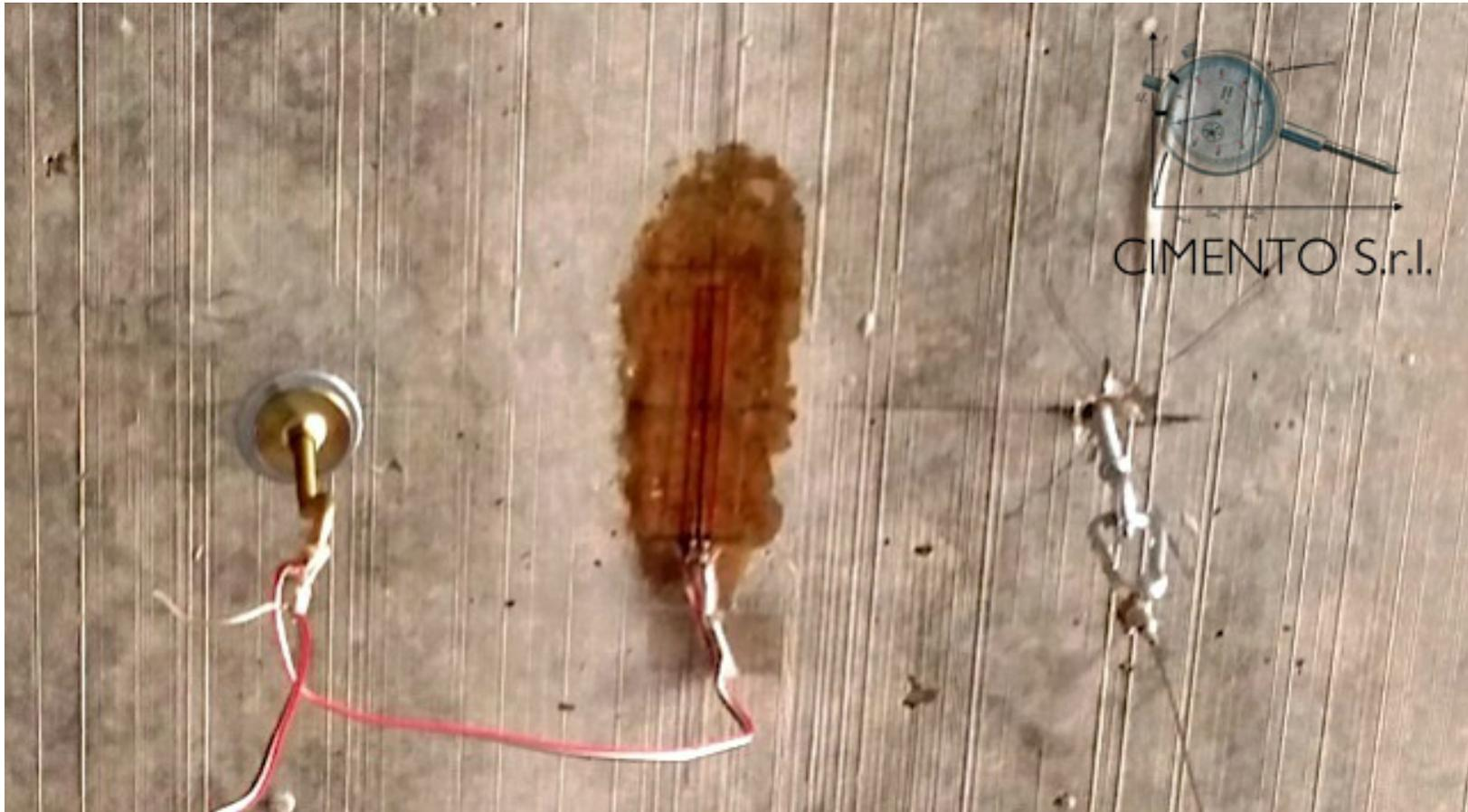
Strain gauge installato all'intradosso di un tegolo in c.a.p. per la misura della deformazione all'intradosso durante una prova di carico
