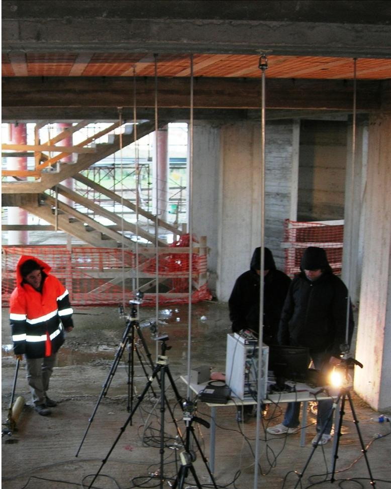
In tal caso vi è la necessità da parte dello sperimentatore di eseguire le letture direttamente, recandosi materialmente in prossimità del comparatore e di conseguenza al di sotto dell'elemento caricato.
