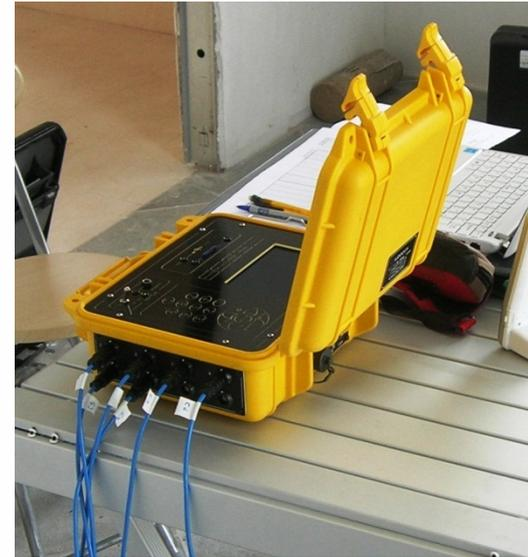
Tali dispositivi vengono collegati ad apposite centraline che acquisiscono ed elaborano il segnale in remoto, grazie a cavi o via wireless, consentendo allo sperimentatore di operare in tutta sicurezza anche a notevole distanza dalle aree caricate.
