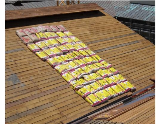
La zavorra occorrente per materializzare i carichi distribuiti di prova può essere costituita, in relazione alle disponibilità del cantiere e delle esigenze della stessa prova, da pallet di laterizi, da sacchi di materiale in polvere (cemento, calce, premiscelati, etc.), da bidoni, serbatoi o vasche da riempire con acqua, etc.
