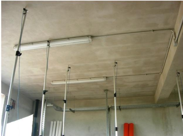
La fasi esecutive di una prova di carico, con zavorra costituita da acqua in serbatoi e misurazioni degli abbassamenti effettuate con trasduttori di spostamento e centralina di acquisizione, possono pertanto così riassumersi:
