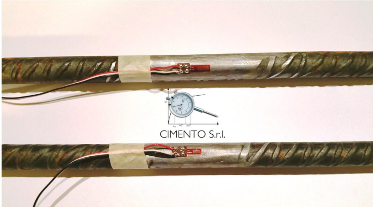
Barre di armatura da c.a. strumentate con Strain Gauge per la misura delle deformazioni
