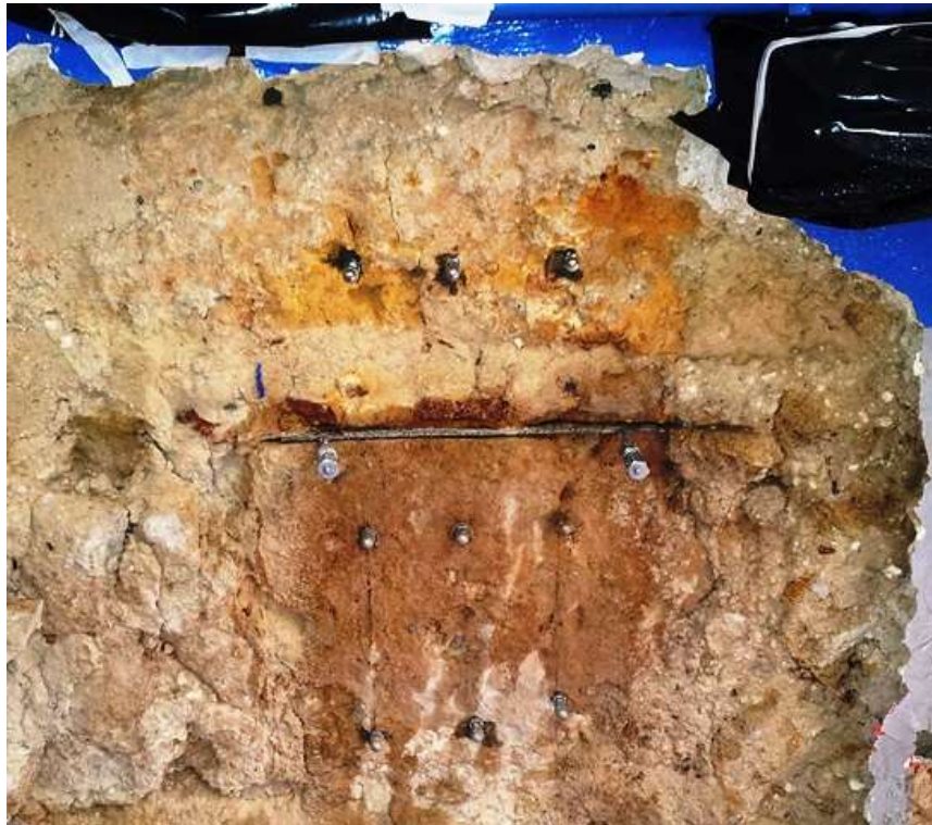
Martinetto piatti in configurazione singola
