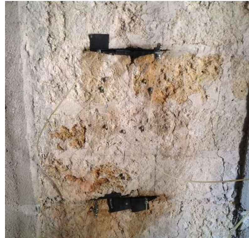
Martinetto piatti in configurazione doppia
