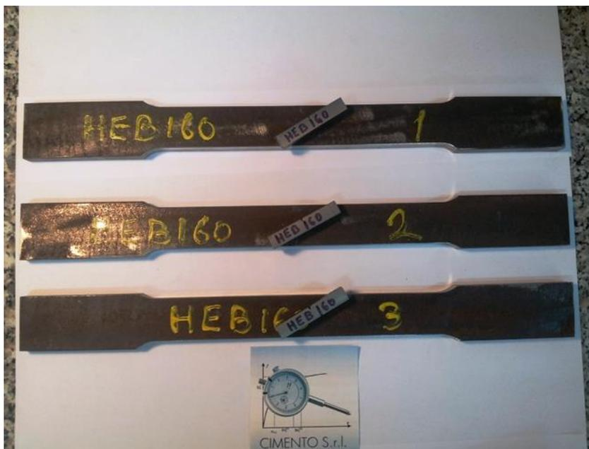
**Provette di acciaio per prova a trazione e prova di resilienza**
