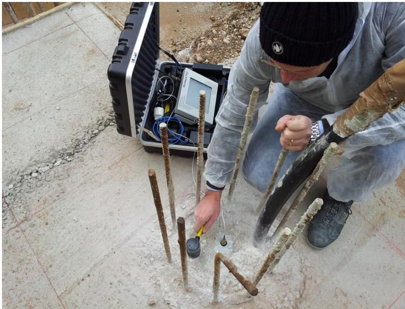
**Esecuzione di indagine Pile Integrity Test**
