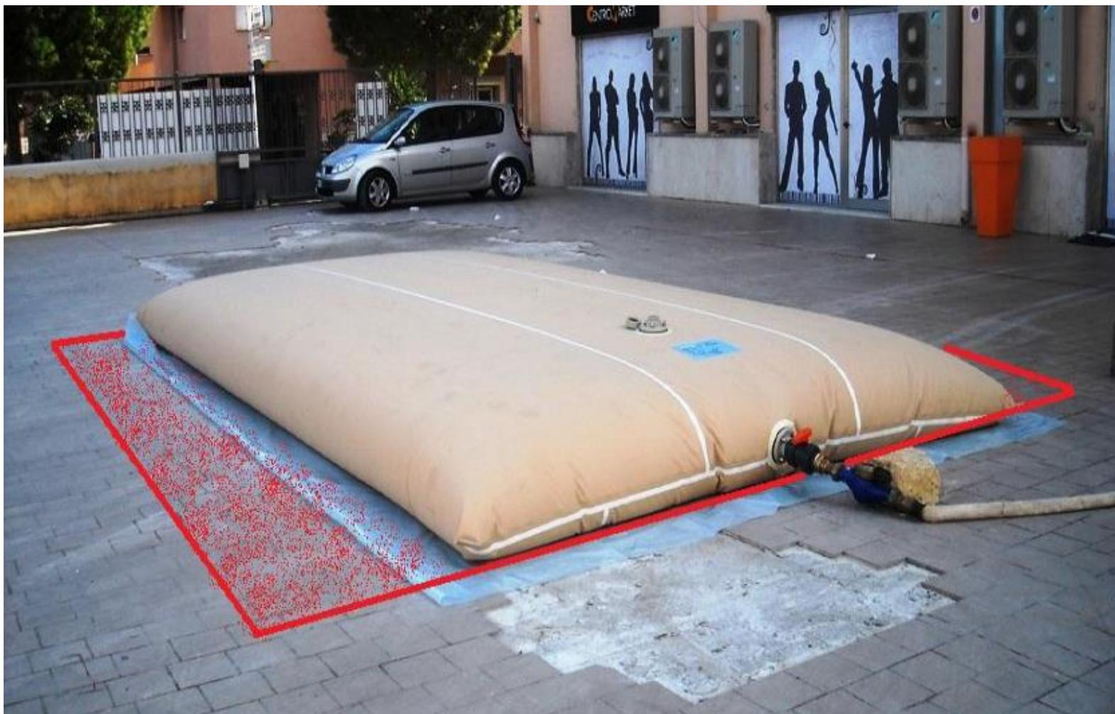
**Esempio di prova di carico: serbatoio zavorra**
