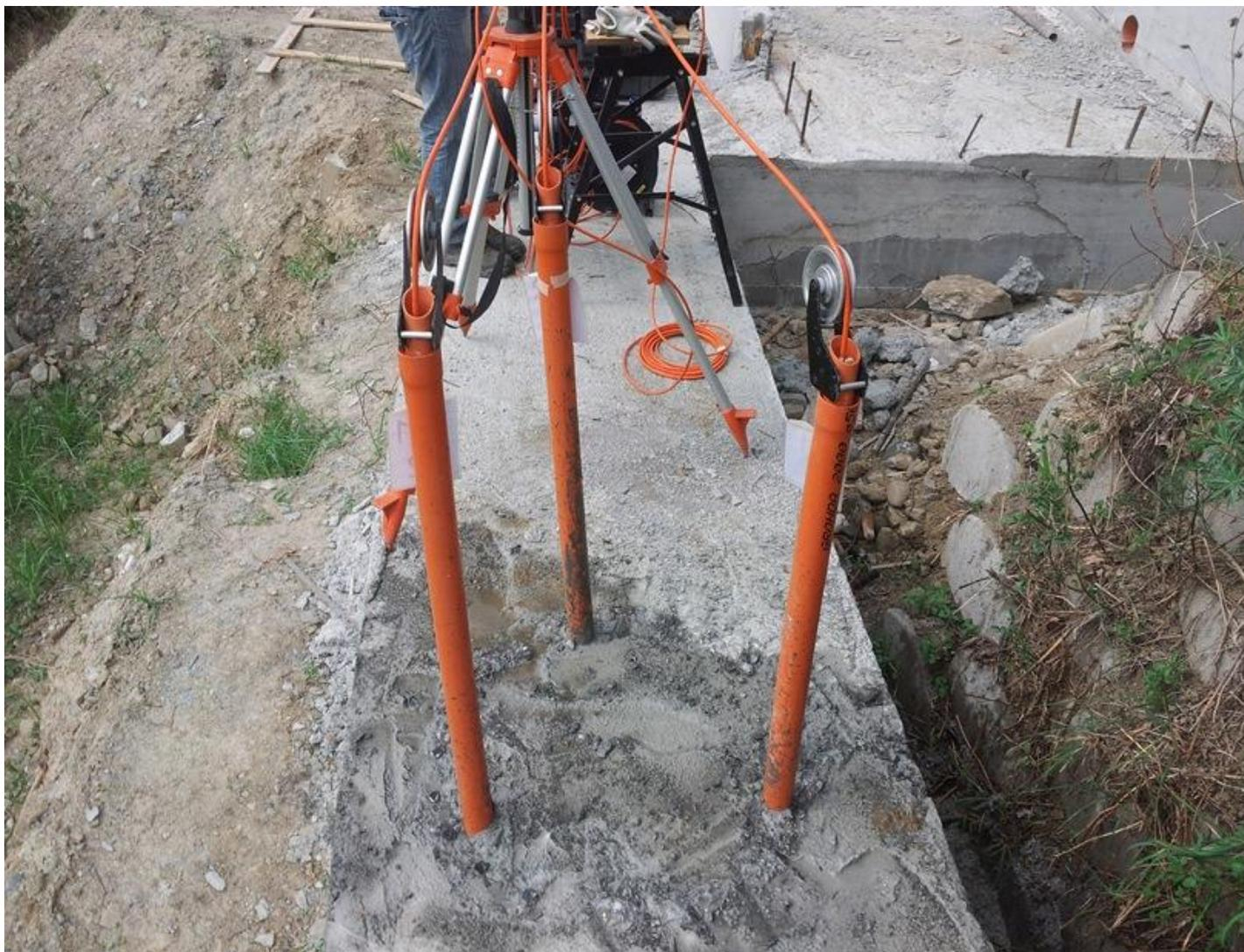
**Esecuzione di prova Cross-Hole**
