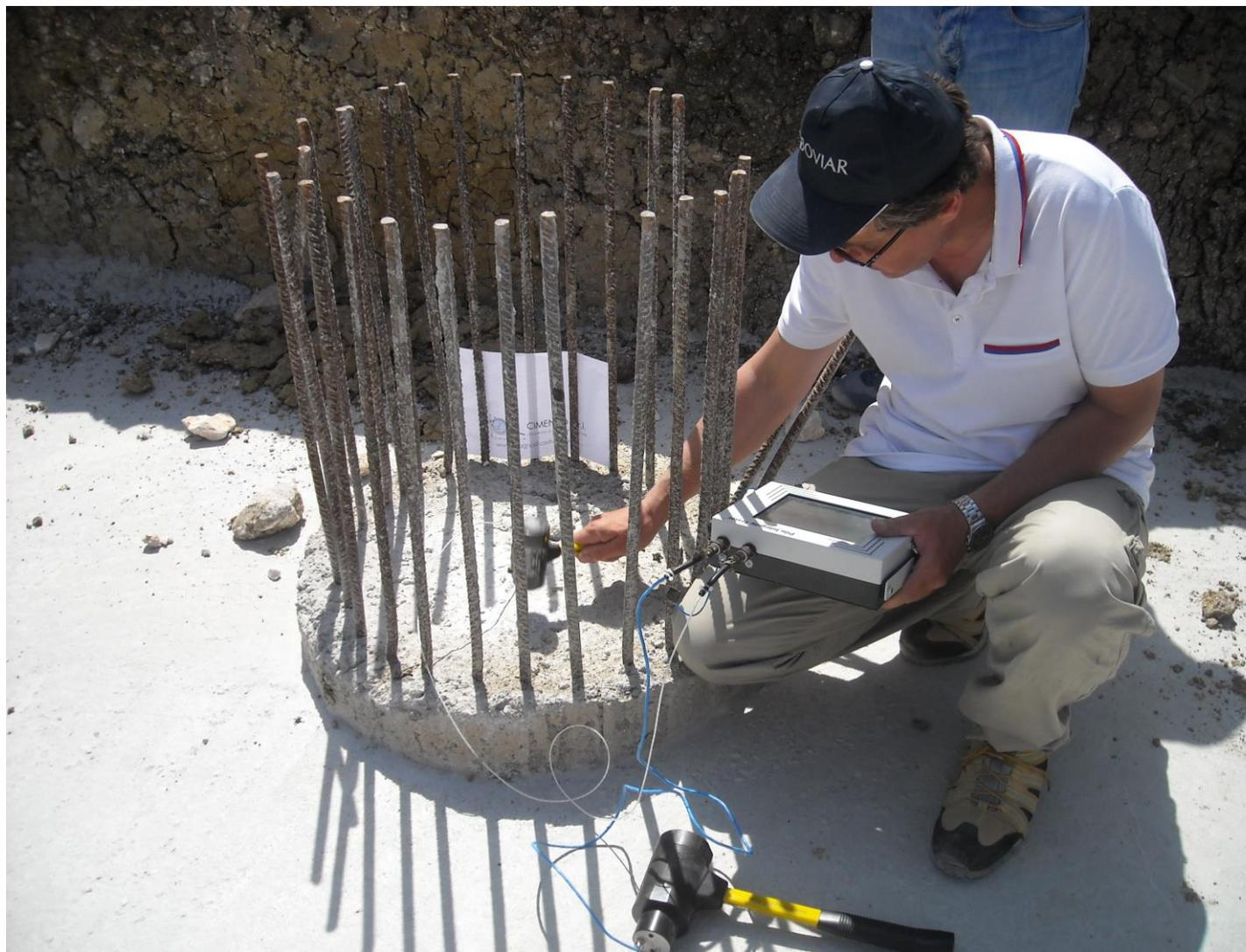
**Esecuzione di indagine Pile Integrity Test**
