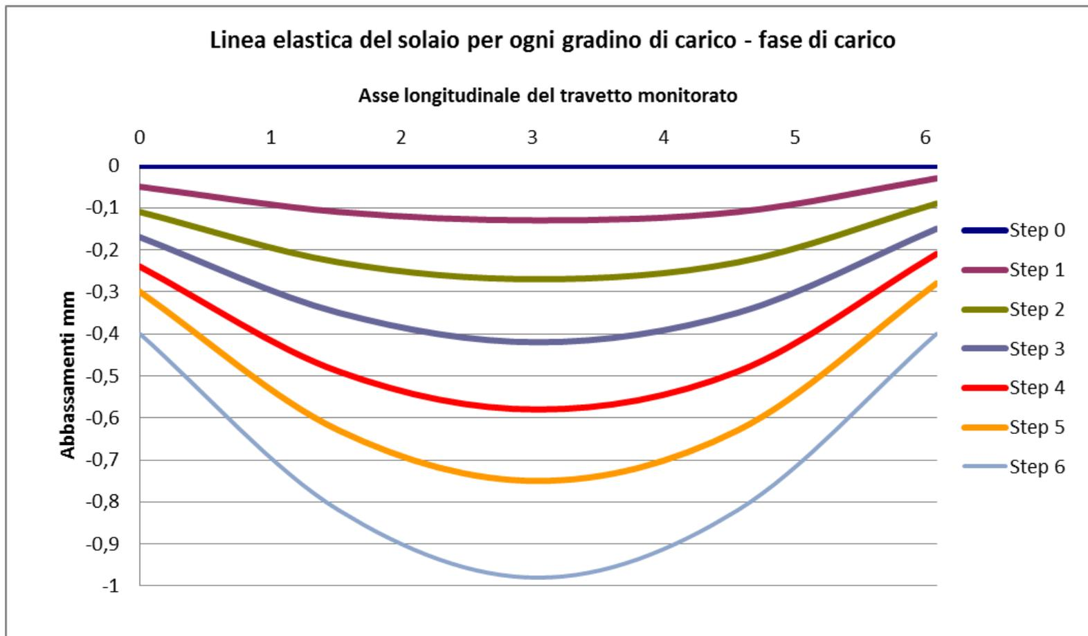
**Esempio di prova di carico: andamento linea elastica nella fase di carico**
