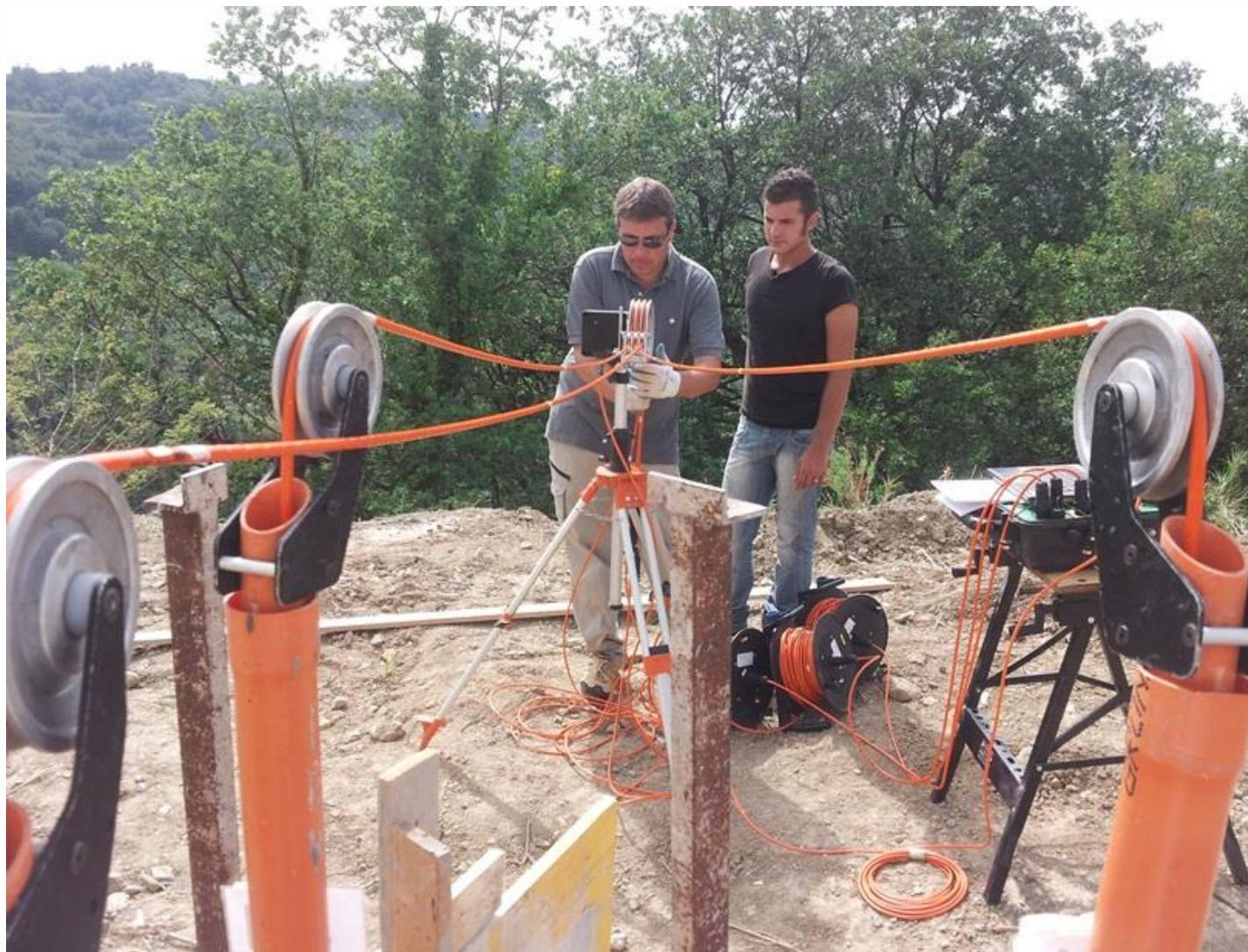
**Esecuzione di prova Cross-Hole**
