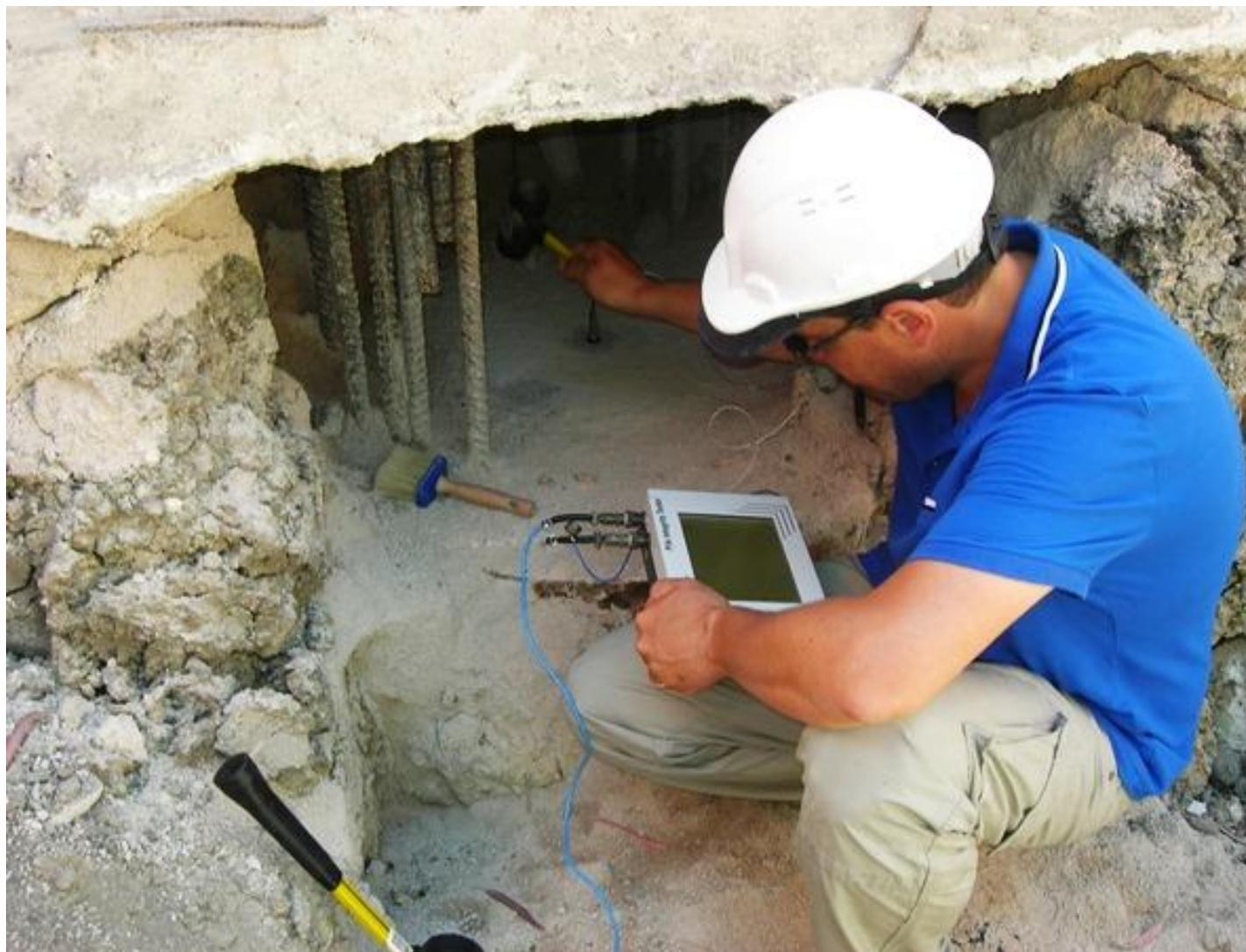
**Esecuzione di indagine Pile Integrity Test**
