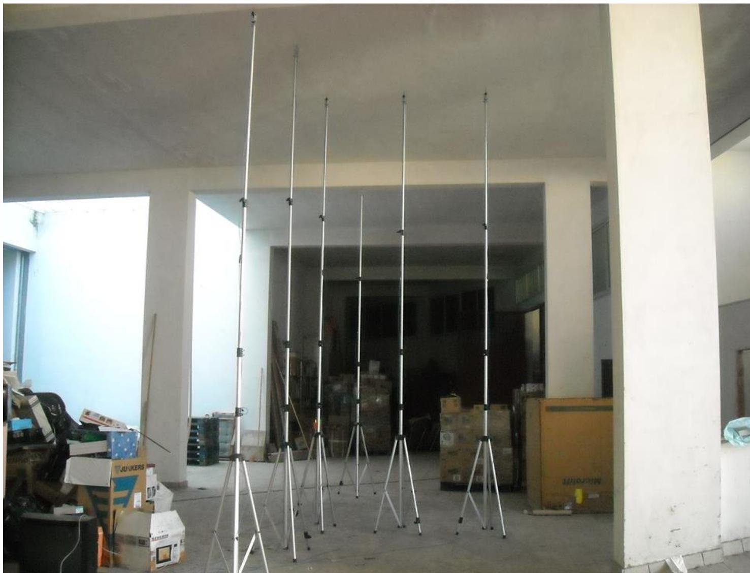
**Esempio di prova di carico: disposizione trasduttori di spostamento**
