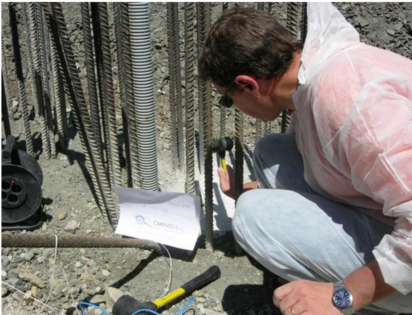
**Esecuzione di indagine Pile Integrity Test**
