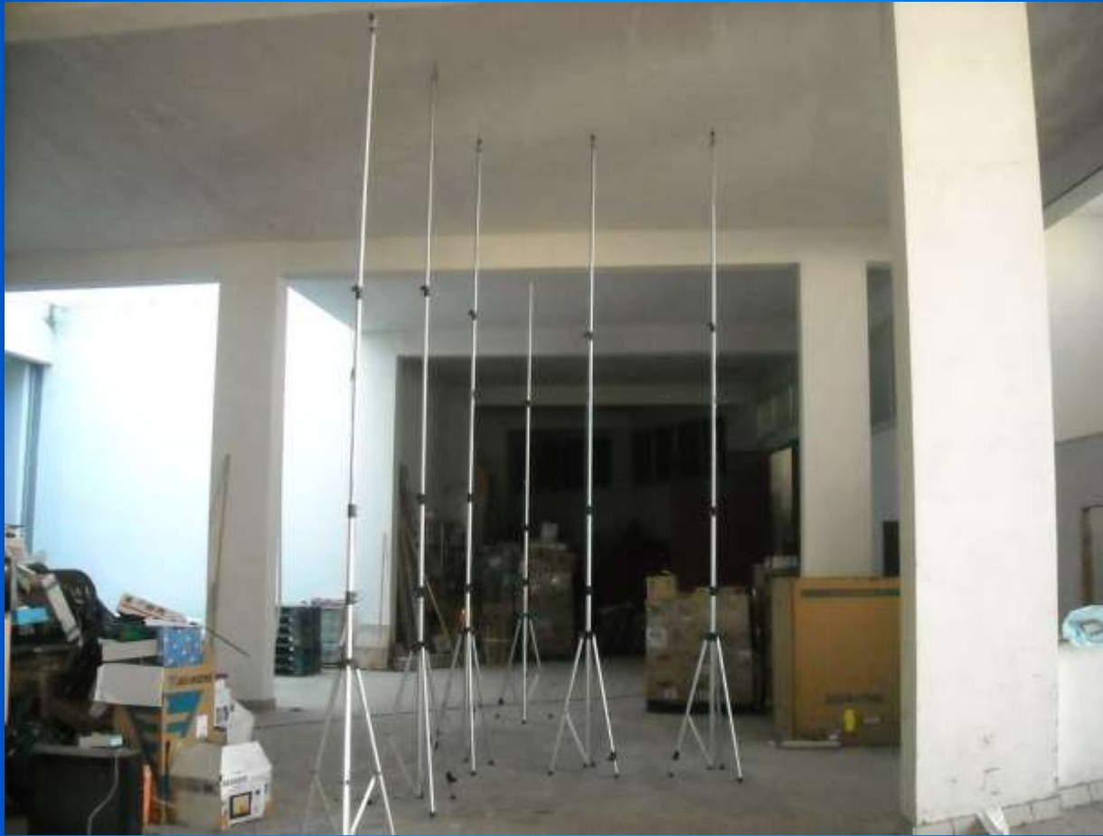
TRASDUTTORI DI SPOSTAMENTO ALL'INTRADOSSO DEL SOLAIO
